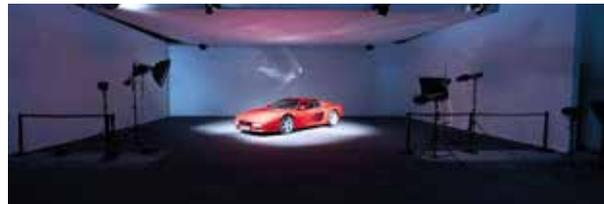
Drehbühne | 5,5 Meter Durchmesser | mit 4,5 t belastbar. Perfekte 360°-Fotografie von Autos und Großprodukten.
